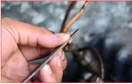
4- گلوپلگ کو بیٹری کی تار سے چیک کریں اور کام نہ کرنے کی صورت میں اس کو تبدیل کر دیں۔
